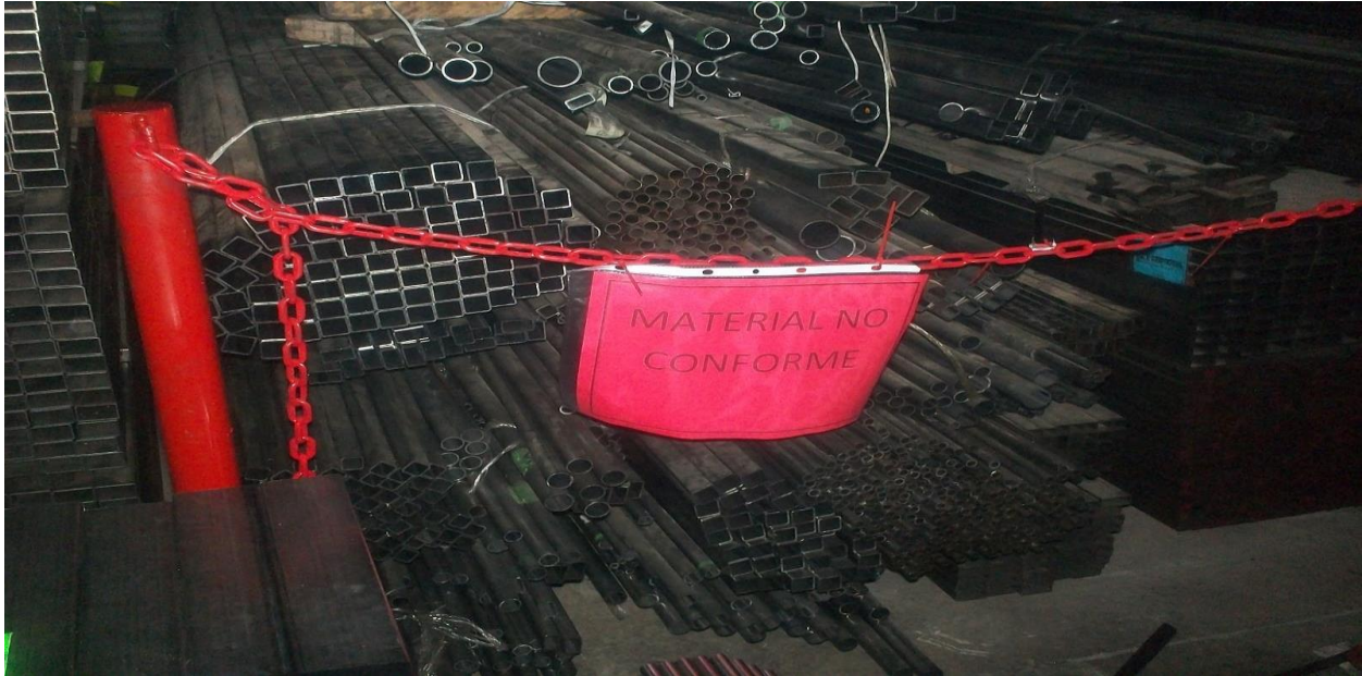
Imagen 9. Material no conforme
